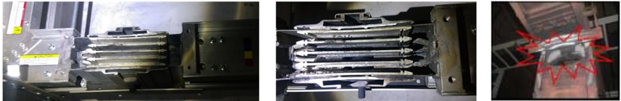
圖 9 匯流排槽接頭短路燒毀案例
